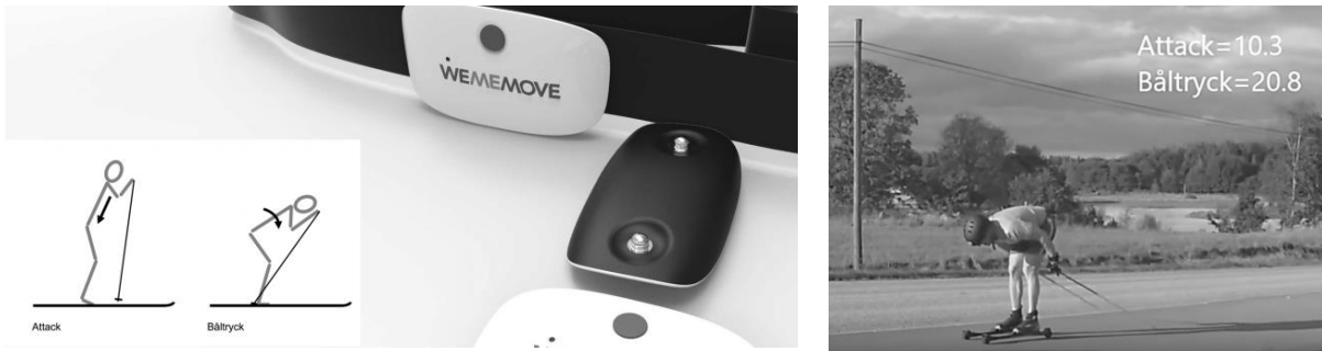
Рис. 5. Датчик MeWeMove, позволяющий оценивать эффективность отталкивания палками в лыжных гонках
