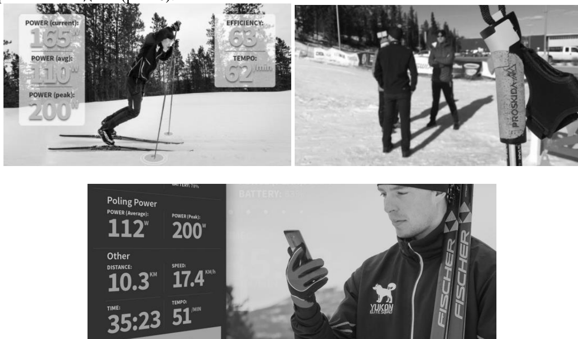
Рис. 6. Измеритель мощности Proskida, встроенный в лыжные палки
